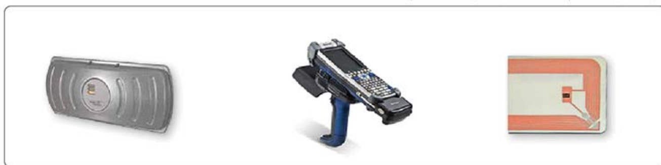
شکل ۱: اجزای یک سیستم RFID (تگ، کدخوان، آنتن) و شمای سیستم RFID
