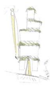
تصویر ۱۷: بازتابش نور توسط آینه و هدایت آن به زیرزمین، بانک هنگ کنگ، فاستر
