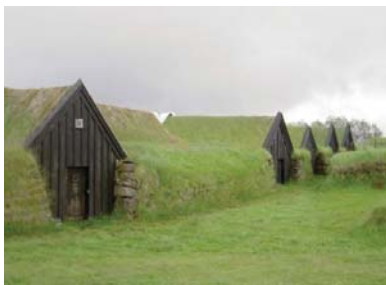
تصویر ۱۱: استفاده از زمین به عنوان جرم حرارتی
