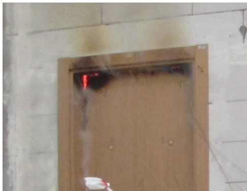
شکل ۷-۷ عملکرد ناصحیح درهای مقاوم در برابر آتش در نتیجه استفاده از مصالح ساخت نامرغوب
