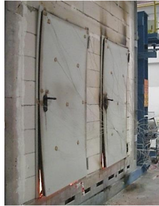
شکل ۷-۹ عملکرد ناصحیح در آتش در نتیجه نصب نادرست
