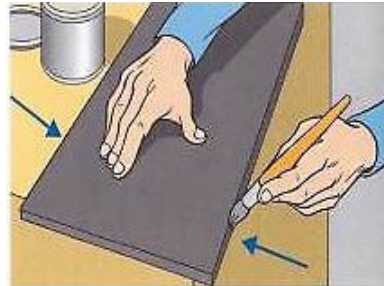
شکل ۵-۶ چسب کاری عایق‌های رولی
