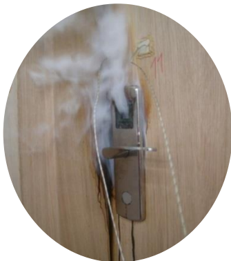
شکل ۷-۷ عملکرد ناصحیح درهای مقاوم در برابر آتش در نتیجه استفاده از مصالح ساخت نامرغوب
