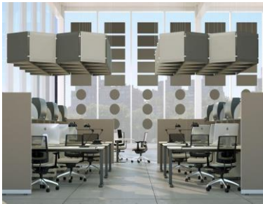
شکل ۶-۳۰ استفاده از بافل‌ها در سقف
