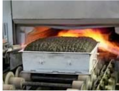
شکل ۶-۱۴ خروج قالب از کوره
