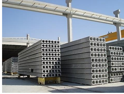
شکل ۲-۲۱ نمایی از قطعات هالوکور
