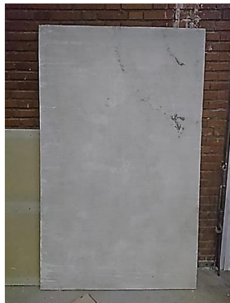
شکل ۲-۲۹ پانل کامپوزیتی متشکل از پارچه سه بعدی شیشه، پر شده با ملات سیمانی
