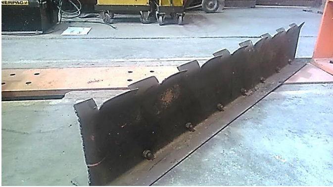
شکل ۲-۷ تصویر تیرچه فولادی از ورق خم شده
