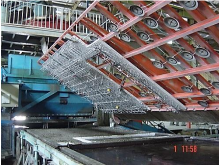
شکل ۱-۸ لایه اول پانل دیوار در حال فرود روی لایه دوم
