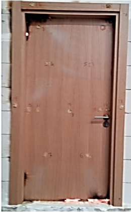
شکل ۷-۹ عملکرد ناصحیح در آتش در نتیجه نصب نادرست
