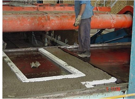
شکل ۱-۷ پانل دیوار در مرحله بتن ریزی و تراکم روی میز لرزان
