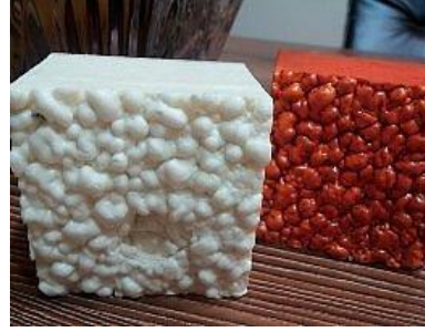
شکل ۶-۸ پلی یورتان صلب پاششی اجرا شده
